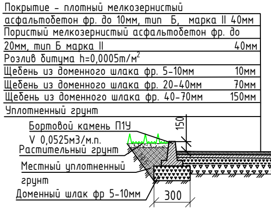
КОНСТРУКЦИЯ ДОРОЖНОЙ ОДЕЖДЫ РАСШИРЕНИЕ ПРОЕЗДА ТИП 1
